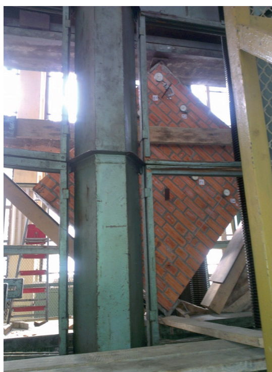
Рис. 4. Випробування зразків стінових конструкцій на пресі ИПС-1000
