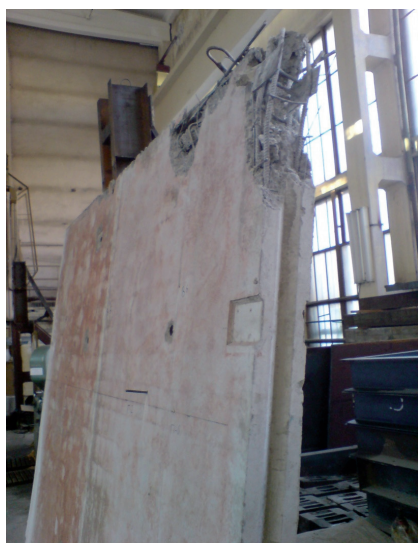
Рис. 8 Випробування зразків стінових панелей.
