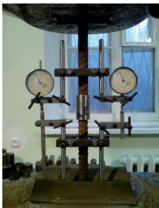
Рис. 6. Дослідження механічних з'єднань арматури
