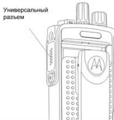
Рисунок 7 – встановлення кришки універсального роз'єму (пілозахисної кришки).
