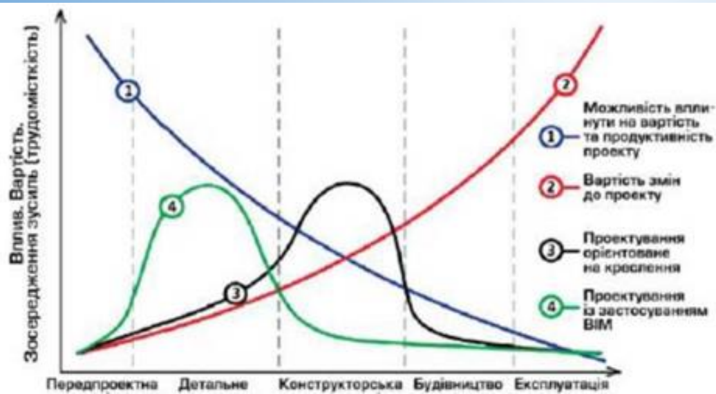
Рис. 3. Зміна ціни та можливостей внесення змін у проект із часом від початку проектних робіт при звичайному проектуванні та із застосуванням BIM
