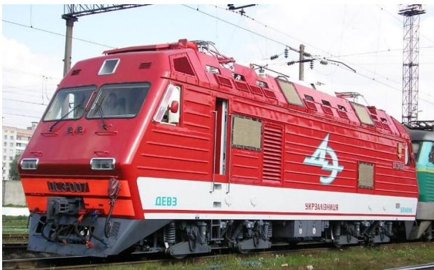
Електровоз ДС3 - електровоз змінного струму, виробництва Дніпропетровського електровозобудівного заводу спільно з Siemens.
