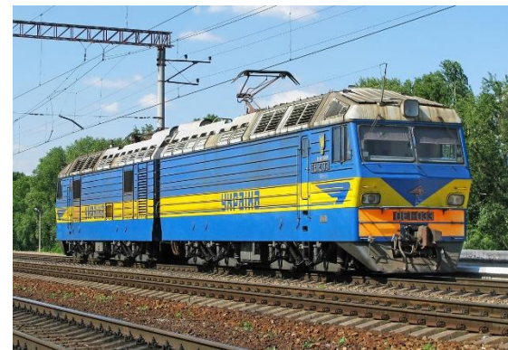
Електровоз ДС3 - електровоз постійного струму, виробництва Дніпропетровського електровозобудівного заводу
