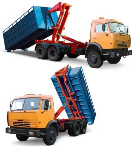
Рис. 1.2. Навантаження та розвантаження змінного кузова до автомобіля, оснащеного системою «мультиліфт»
