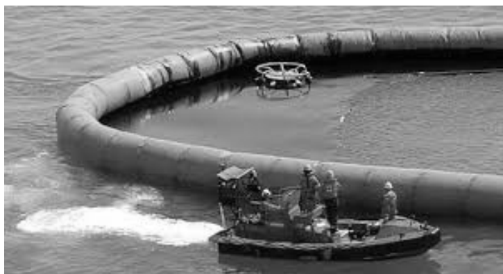
Рис. 7.6. Загальний вигляд бонового огородження
