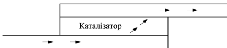
Рис. 4.21. Принципова схема каталітичного нейтралізатора
