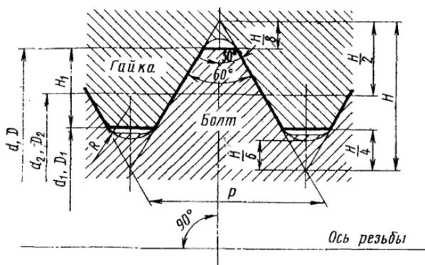
$$d, d_1, d_2 \text{ — диаметры резьбы болта} \quad H = 0,866025P$$
