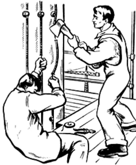
Рис. 2. Звільнення потерпілого від дії електричного струму в електроустановках напругою до 1000 В
