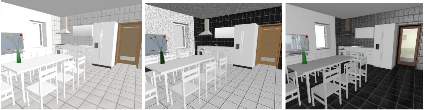
Рис. Залежність зображення від алгоритму візуалізації: на екрані; алгоритм Internal Engine ; алгоритм Light-Works
