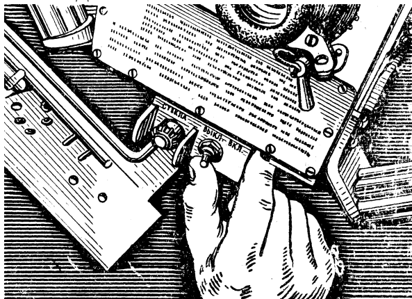
Рис. 51. Ввімкнення обігріву приладу ТКН-ЗБ
