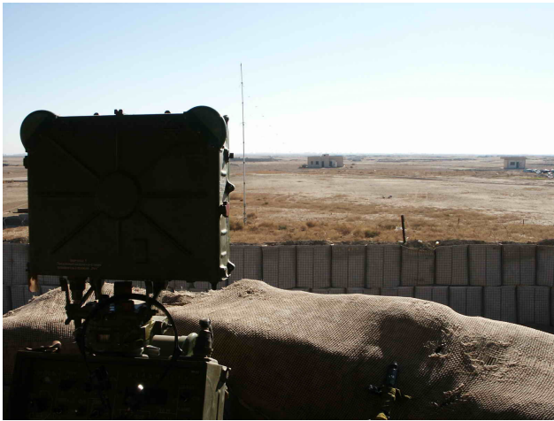
Станція ближньої розвідки СБР-3 на спостережному посту (Ірак).
