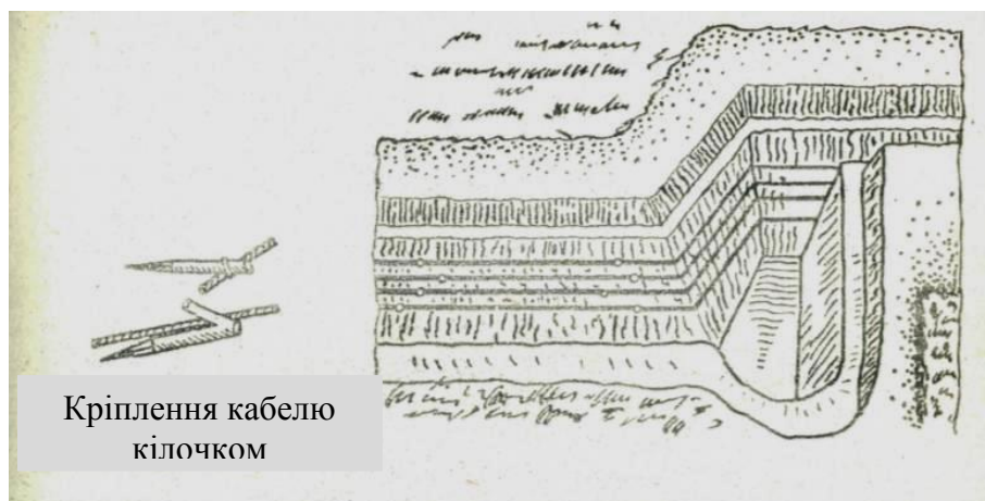
Рис. 37. Кріплення кабелю в траншеї
