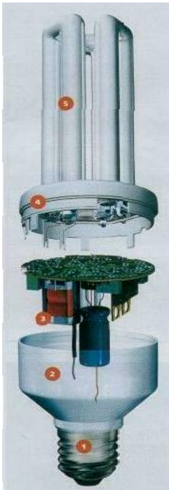
Рисунок 8.6 – Загальний вигляд компактної енергоощадної люмінесцентної лампи: 1, 2 – цоколь з гвинтовою різьбою (E14;E27); 3 – вбудований пускорегулювальний апарат; 4 – цокольний ковпачок; 5 – люмінесцентна світна трубка.
