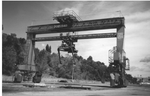
Fig. 8.5.13. 40 te gantry crane
