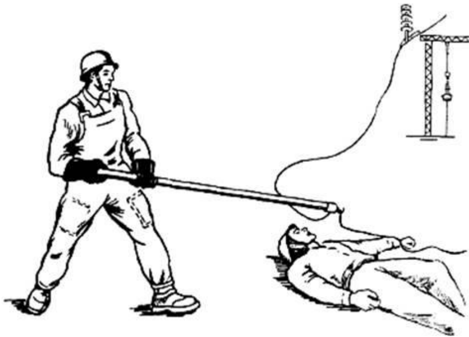
Рис. 2. Звільнення потерпілого від дії струму в електроустановках напругою понад 1000 В ізольовуючою штангою
