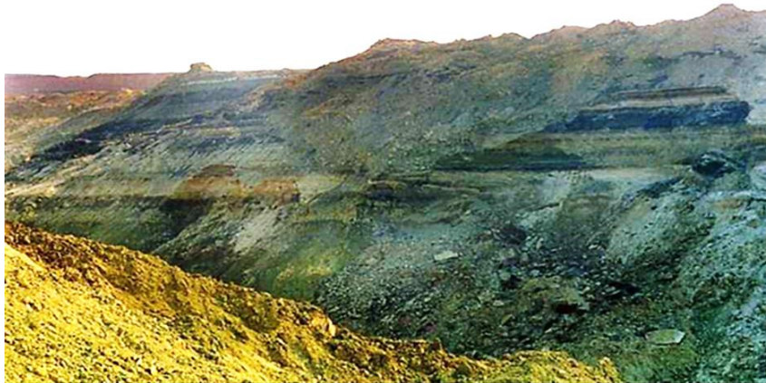
Рис. 2. Кар'єр на Марганцевському родовищі з 2-метровим рудним пластом
